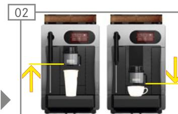
Отрегулируйте высоту дозатора.
