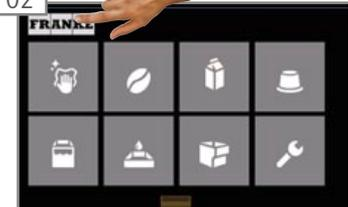
Нажмите логотип Franke, чтобы перейти в режим программирования. Отображается цифровой блок для ввода PIN-кода.
