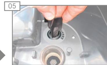
Настройте тонкость помола с помощью соответствующего ключа.
