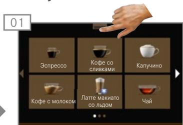
Нажмите на значок «Шторка», чтобы отобразить панель управления.
